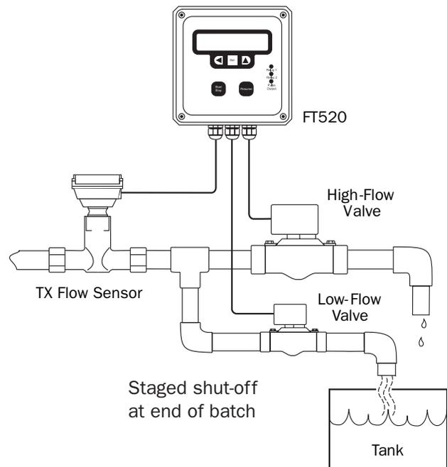
**CONNECTION FOR STAGED SHUT-OFF**
